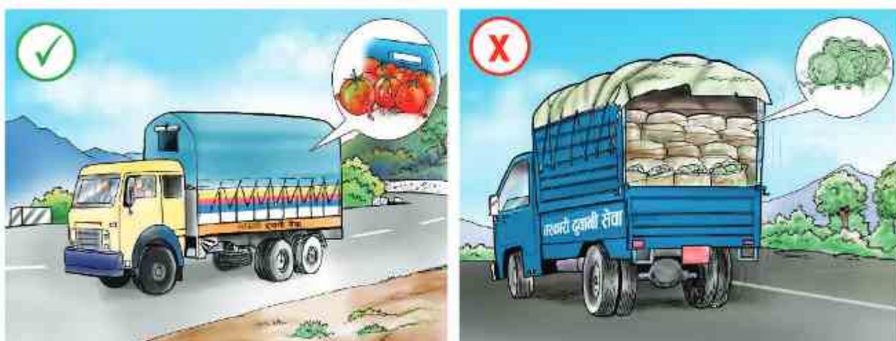
चित्र ९९ : घामपानीबाट बचाउन हुवानीको गाडीलाई केही हावा खेल्ने गरी छोप्नु पर्दछ । (स्रोत : VCDP, 2077)
